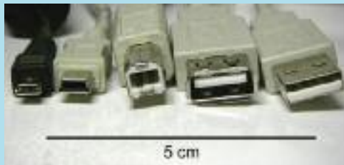
[198] Distintos tipos de conectores USB
