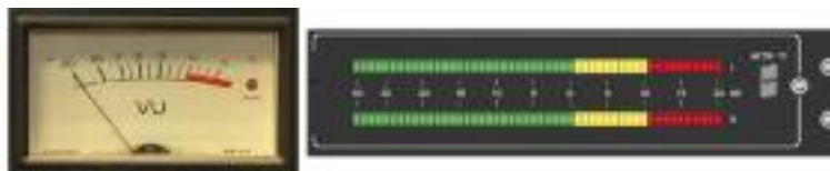
[224] Aunque a ambos se les conoce como vúmetros o VU-Meter, los de “lucecitas” reciben el nombre de Peak Meter
