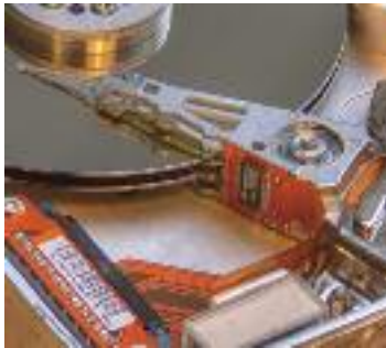
[197] Detalle interno de un HD
